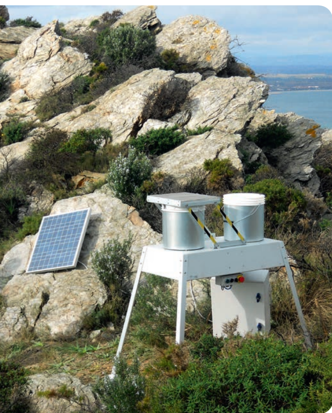
▲ Système de collecte des retombées atmosphériques au Cap Béar. © D. Aubert
