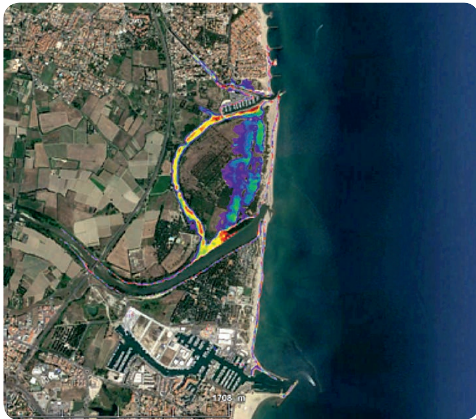
▲ Modélisation d'inondation par débordement de la Têt (Pyrénées-Orientales) et par submersion marine. Les couleurs indiquent les zones recouvertes d'eau. Dans ce cas, les zones inondées correspondent principalement à l'ancien lit de la Têt et à des zones non constructibles entre l'ancien lit et le lit actuel. © P. Marsaleix/Laboratoire d'Aérodynamique
